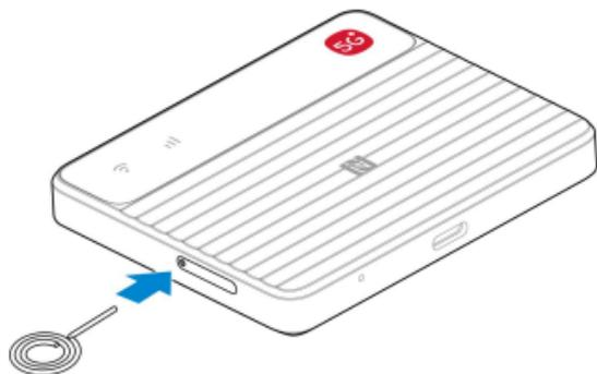
2. 将 nano-SIM 卡放到卡托的上卡位或下卡位中，随后将卡托推回卡槽中。
